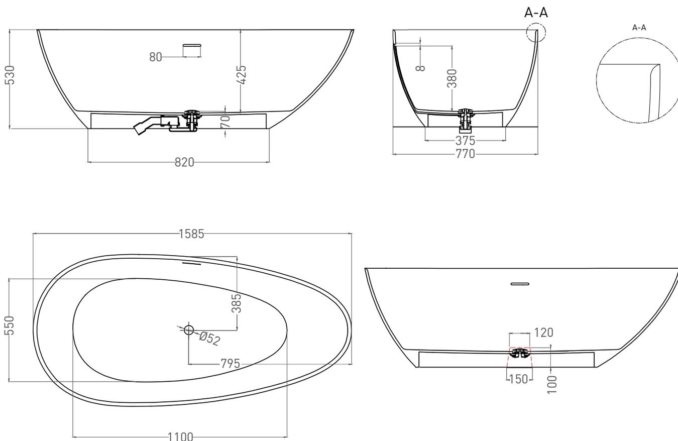
\* Расположение стандартного технологического отверстия на задней стенке. В базовую комплектацию не входит, заказывается отдельно.
